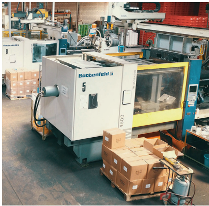
Bild 2. Für den Energievergleich mit der EcoPower wurde eine Spritzgießmaschine Battenfeld TM 4500 herangezogen. © Teko-plastic
