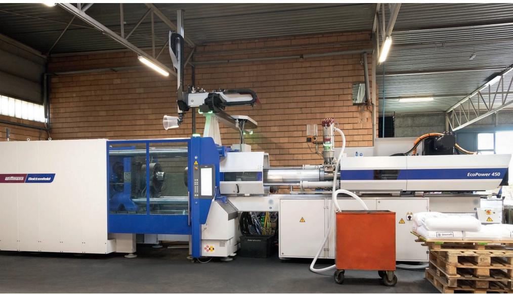
EcoPower 450/3300 mit Fördergerät Feedmax basic und Roboter W832 pro, der gerade einen Eimer aus der Maschine entnimmt. © Wittmann Battenfeld
